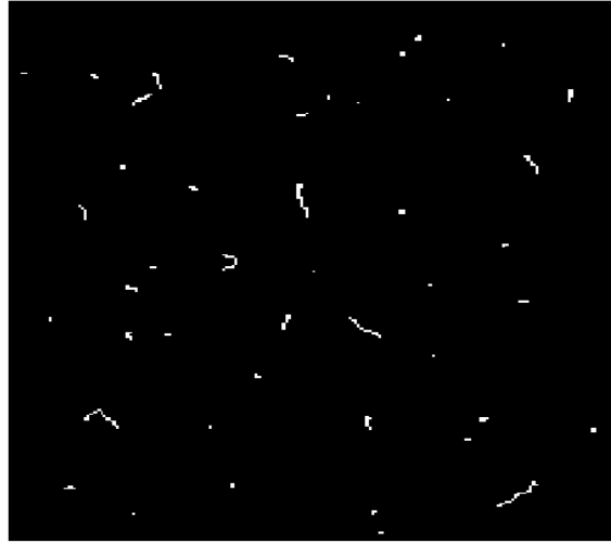
Figure 2.7 – Image prise par un détecteur MPX exposé aux photons et aux électrons émis par une source de ^{137}\text{Cs} . La mesure a été faite avec un temps d'exposition de 0.1 s, un seuil de détection de 8 keV et une tension de polarisation de 100 V.
