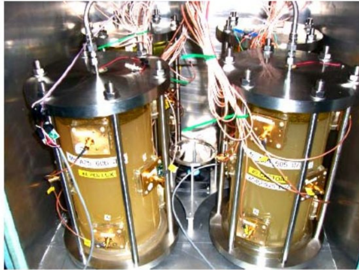
Figure 8.1 – Vue extérieure d’un des huit TPCS où se trouvent quatre des 32 modules de détection.
