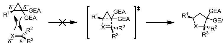
(a) Cycloaddition [3+2] : mécanisme concerté
