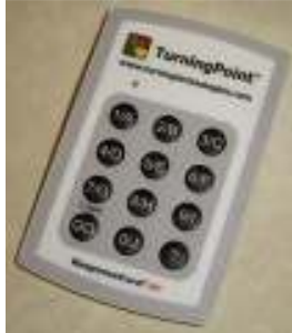
Figure 1. Télécommande utilisée dans un système de télévotants
