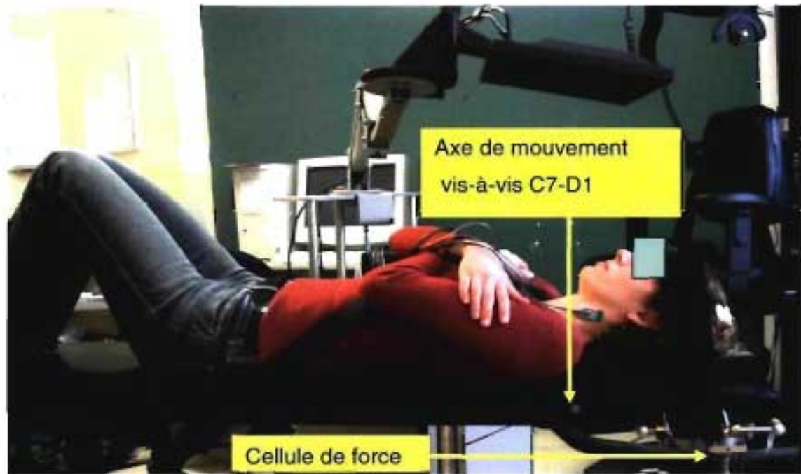
Figure 2 : Appareillage et positionnement du sujet lors des mesures en position couchée sur le dos
