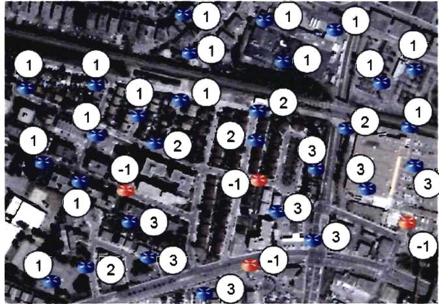
Figure 6.9. Nombre de passerelles desservi par routeur sans fil Nombre de sauts de 3
