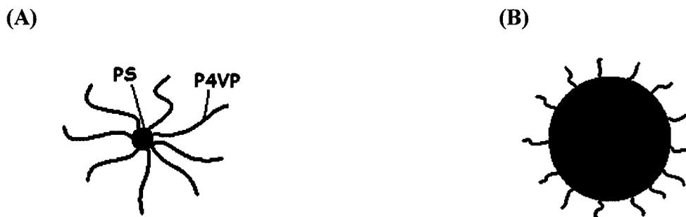
**Figure 9** : Représentation schématique des deux types de micelles : 'starlike' (A); 'crew-cut' (B)
