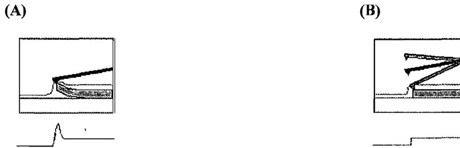
**Figure 16** : Schématisation des deux principaux modes d'imagerie en AFM : mode contact (A); mode 'tapping' (B) (Wang, 1997)
