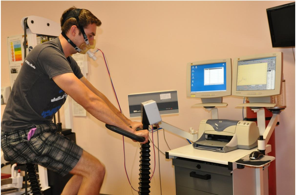
Figure 3 : Mesure de la DE sur ergocycle (photo laboratoire de l'IRCM)
