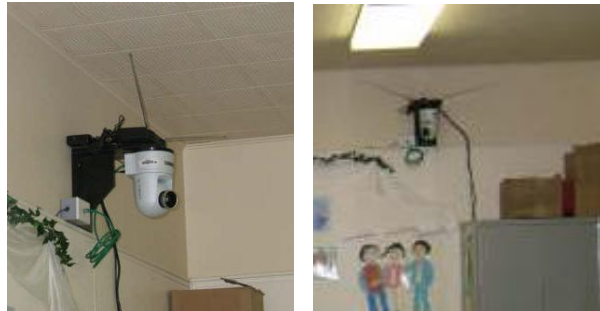
Figure 11 Caméra robotisée installée au plafond de la classe
