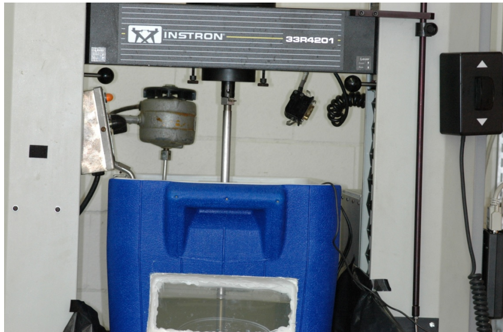
Figure 18 : Montage du test avec la sonde au centre reliée à la cellule de charge; le chauffe-eau et l'agitateur de vitesse sont situés à gauche du montage.
