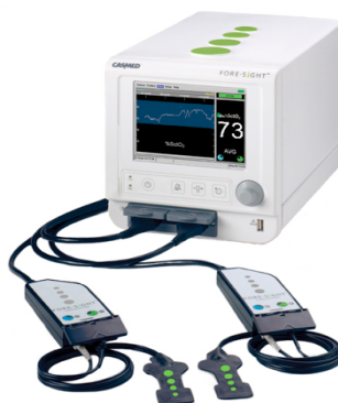
Figure 14. Moniteur FORE-SIGHT™ avec les câbles (fibres optiques) et les deux senseurs 84
