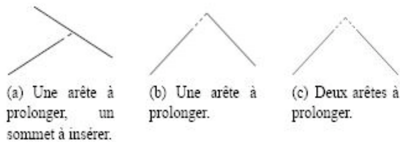
Figure 25: Différents cas de figures pour une opération de couture de deux arêtes.
