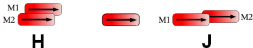
Figure 1.9 – Illustration des agrégats J et H. Un empilement face à face correspond à un agrégat H ( à gauche) un empilement tête à queue correspond à un agrégat J ( à droite ) et au centre le monomère seul. M1 et M2 représentent les moments dipolaires de transition et les rectangles rouges schématisent les monomères.
