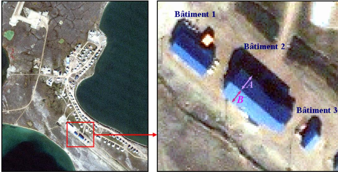
Figure IX-3. Image Ikonos de la région de Paulatuk, territoire du Nord Ouest, illustrant l'effet de la différence d'éclairage sur des toitures inclinées. Centre de la scène 69° 20' 30" N, 124° 04' 00" O; angle zénithal solaire 60.06°; azimut solaire 182.75°; angle de visée 25.49°; azimut de visée = 287.78°; atmosphère claire (AOD=0.05).
