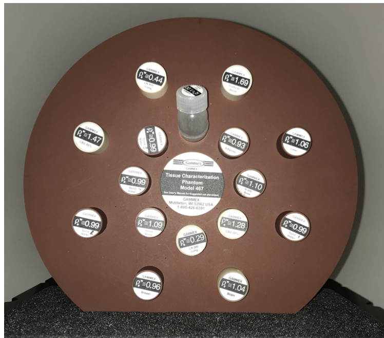
FIGURE 2.2.1. Exemple d'un fantôme d'étalonnage, le Gammex 467 (Gammex Inc., Middleton, WI), utilisé en CT. Les nombres indiqués sur les insertions cylindriques correspondent aux densités électroniques des insertions.
