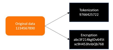
Fig. 3.10. Tokenization VS Encryption
