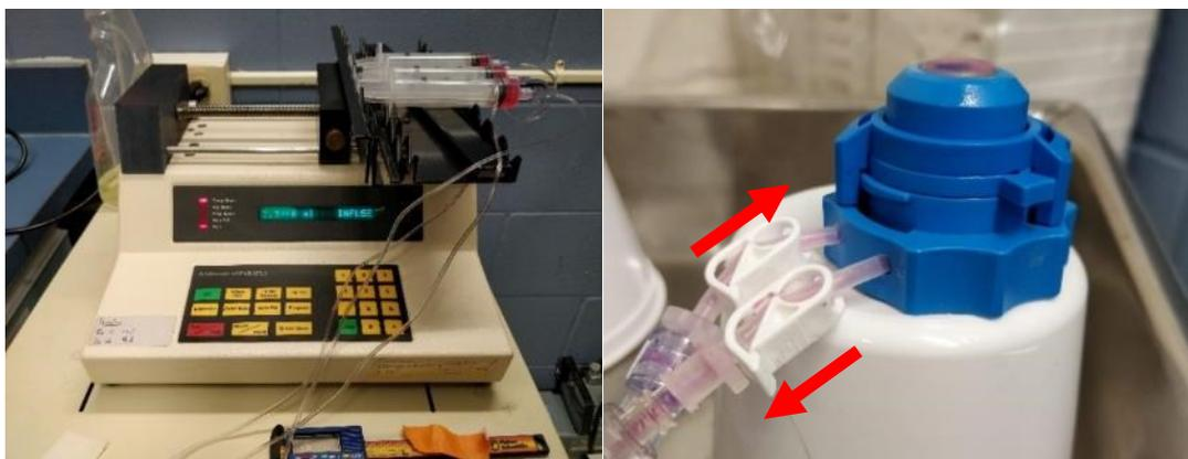
**Figure 15.** Système de perfusion des chambres antérieures grâce à une pompe à seringues.
