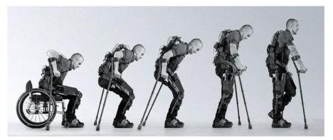
Figure 1 : Aperçu d'un exosquelette robotisé de marche au sol
