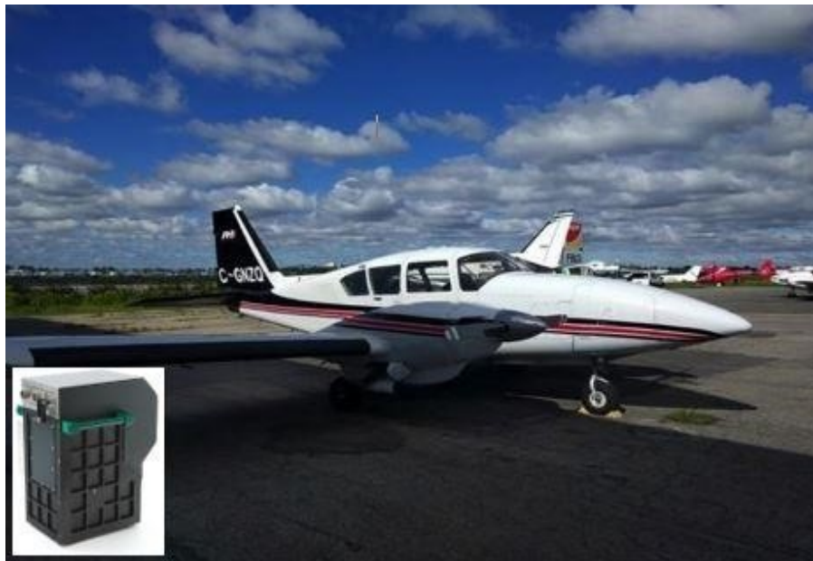
Figure 4-8 Aéronef Piper Aztec (C-GNZQ) avec le capteur CASI-1500.
