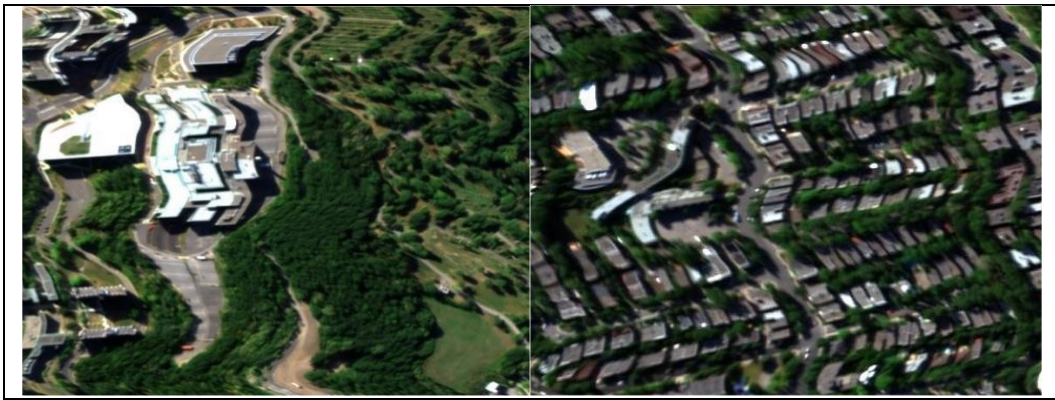
Figure 6-1 Exemples des déformations géométriques des images CASI (mission 2012).
