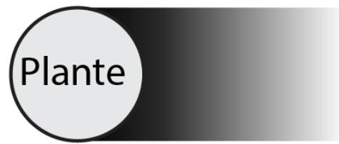
Figure 2.1. - Comparaison du traitement des zones « d'ombre » des éléments de rugosité entre les modèles de Raupach et al. (1993) et Okin (2008). Les zones les plus foncées présentes une force de vent moindre que les zones pâles. (Inspiré de la figure 5 de Okin, 2008).
