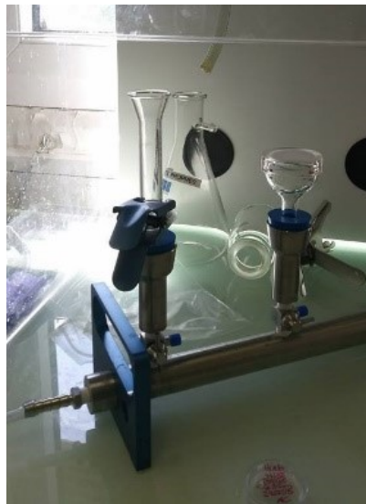
Figure 30 : Station de traitement. Déposition de 1 ml de 12 \mu\text{g} de sol < 63 \mu\text{m} , dilués dans 30 ml d'éthanol. Photo : Amélie Chaput
