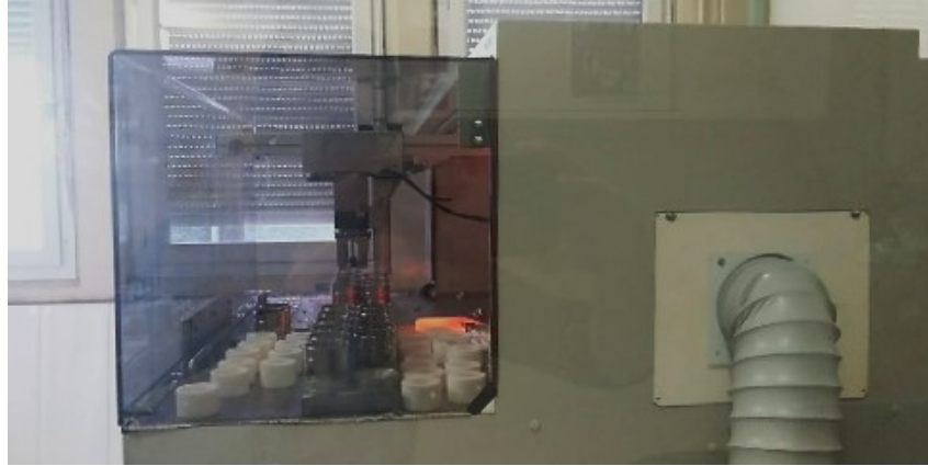
Figure 31 : Instrument d'analyse : Spectromètre de Fluorescence X Panalytical 2404, 4 kW, dispersif en longueur d'onde photo : Amélie Chaput.
