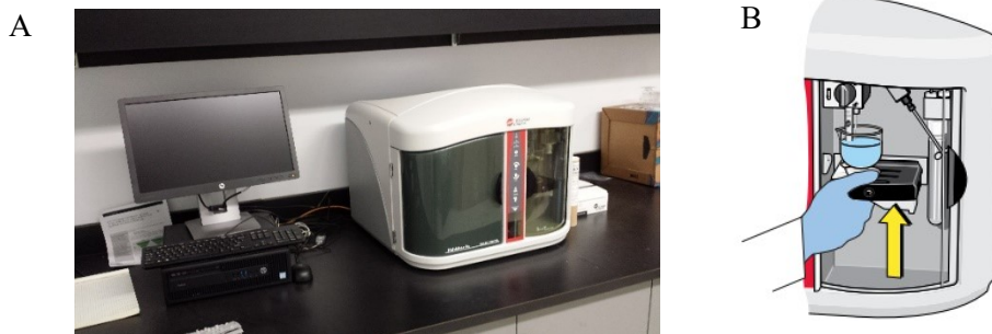
Figure 24 : Représentation du Coulter Counter. a. Multisizer 4e (Photo prise par : Amélie Chaput), b. Multisizer 4 e (Petkov, 2011)
