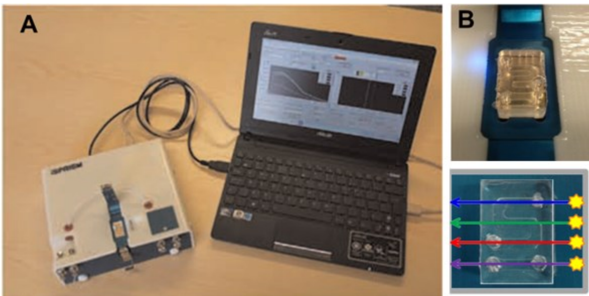
Figure 4 : A) P4-SPR branché à un ordinateur portable. B) Cellule fluidique à quatre zones d'analyse, dont 3, pour réaliser un triplicata de mesure (3 premières flèches en partant du haut) et le dernier servant de référence. 16
