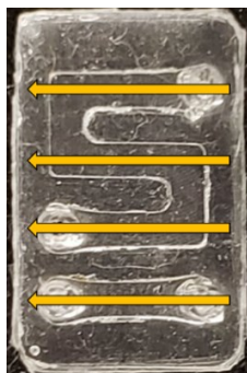
Figure 17 : Cellule fluidique à 4 canaux, utilisée dans la P4-SPR, dont 3 en forme de S servant la réalisation d'un triplicata et 1 de référence utilisée en recouvrant le prisme de Dove recouvert d'une couche d'or.
