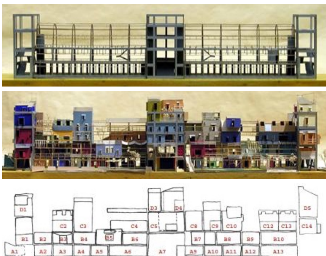
Figure 6-35 - Vues en élévation montrant la diversité à l'œuvre dans le scénario Domestication of an eco-monster proposé pour la gare abandonnée de Milan (Spécimen #009) par l'Atelier Albori. En haut, squelette actuel sous lequel se présente la GSA. Au milieu, proposition de mise en œuvre du scénario reposant sur la construction de 46 maisons à l'intérieur de la structure. En bas, mise en évidence schématique de la diversité des logements insérés sur les 4 niveaux de la structure (niveaux A, B, C et D). Source : Studio Albori, 2008
