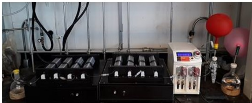
Figure 47. Montage utilisant deux photoréacteurs en série pour la montée en échelle de la réaction de borocyclopropanation photochimique
