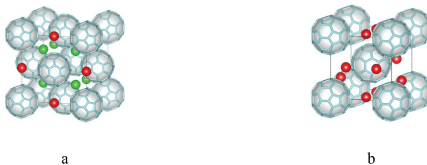
Figure 1.14 : Mailles élémentaires pour un sel de type M_3C_{60} . a) Cubique face centrée. b) Cubique centré. Image tirée de la référence 46.
