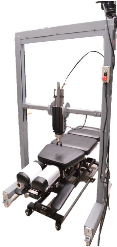
Figure 2.1. Photo (A) et schématisation (B) de l'appareil robotisé. L'appareil est connecté à un ordinateur permettant un contrôle précis afin de simuler une manipulation vertébrale ou -d'évaluer la rigidité vertébrale segmentaire.
