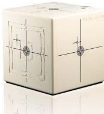
Figure 5-2 : Fantôme QUASAR Penta-guide de la compagnie Modus
