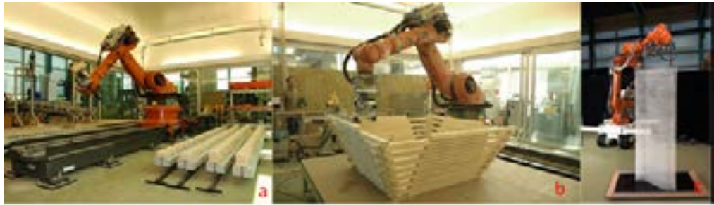
► Figure 6 : Procédés additifs : a) Déposition de briques, (b) Déposition de bois, (c) Impression 3D en résine (Augugliaro et al., 2014).
