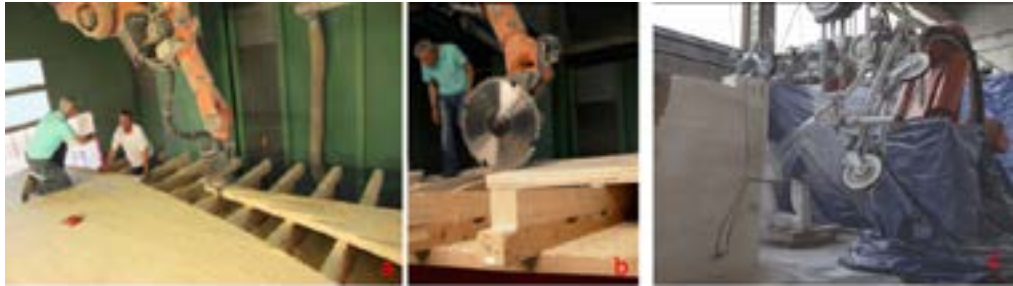
► Figure 7 : Exemples de procédés soustractifs : a) Percement, b) Découpage à scie roulante (Robeller, Nabaei et Weinand, 2014), c) Découpage au fil abrasif en diamant ( https://vimeo.com/121926874 ).
