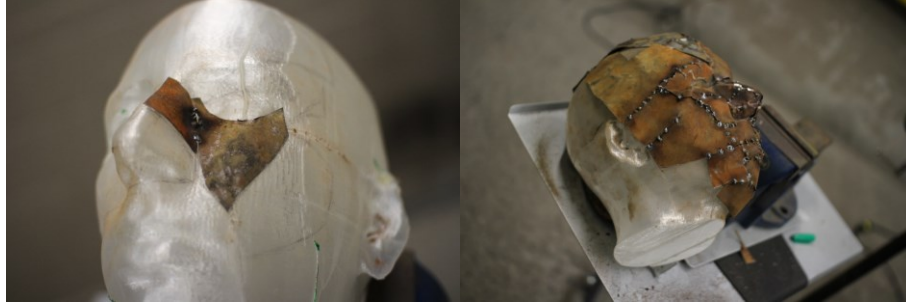
Figure 20 - Plaques métalliques pliées et soudées.
