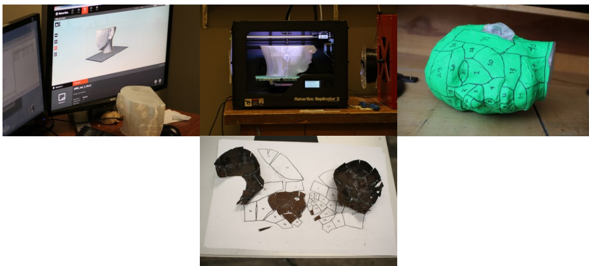
Figure 19 - Impression 3D : guide pour le travail de soudure.
