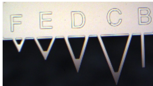
Figure 1.13: Photo d'une série de micro-leviers utilisée en AFM. Dans le cadre de ce projet de recherche, le micro-levier rectangulaire (B) est utilisé.
