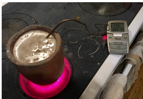
Figure 3.4 Saccharification exécutée à l'aide d'une cuisinière électrique et d'un thermomètre à cuisson.
