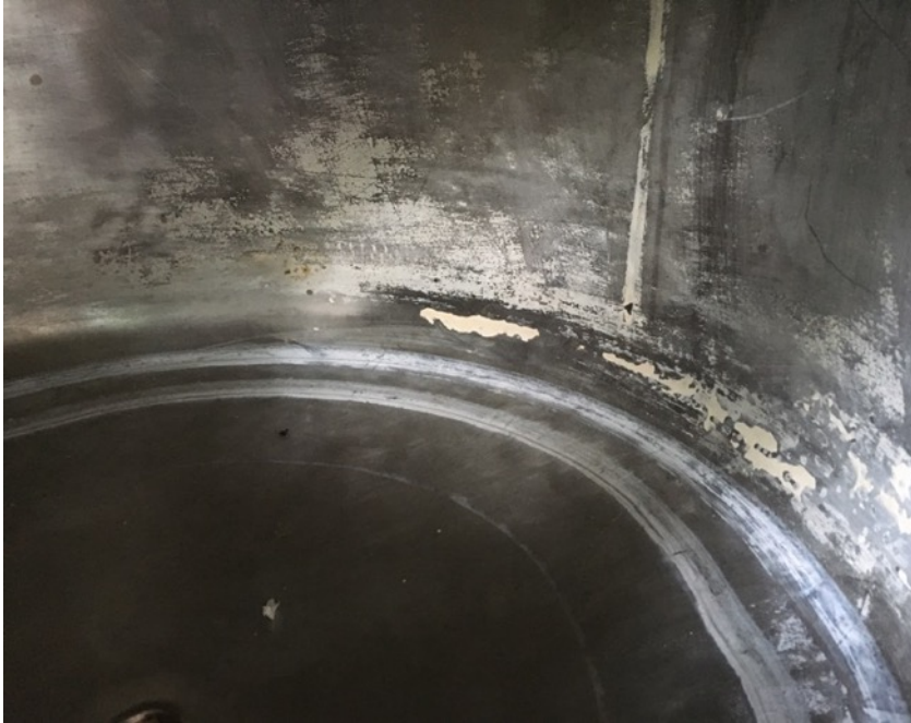
Figure 4.4.1 Plaque d'oxalate de calcium dans le fond d'une cuve de brassage.
