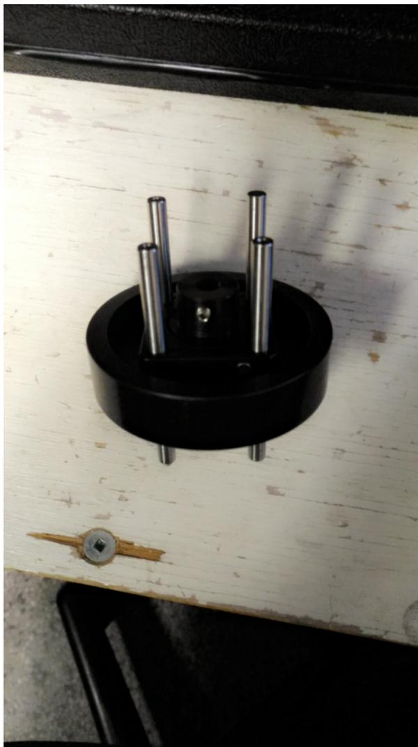
Figure II.4 : Porte-fibre allant dans le détecteur
