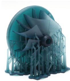
Figure 8: Exemple de support en SLA (18)
