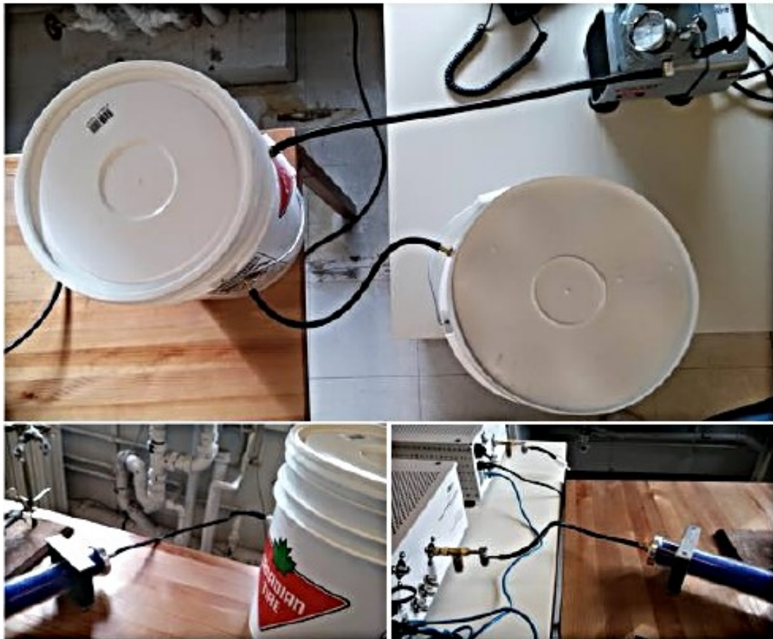
Figure 9. Montage de la calibration en absorbance.
