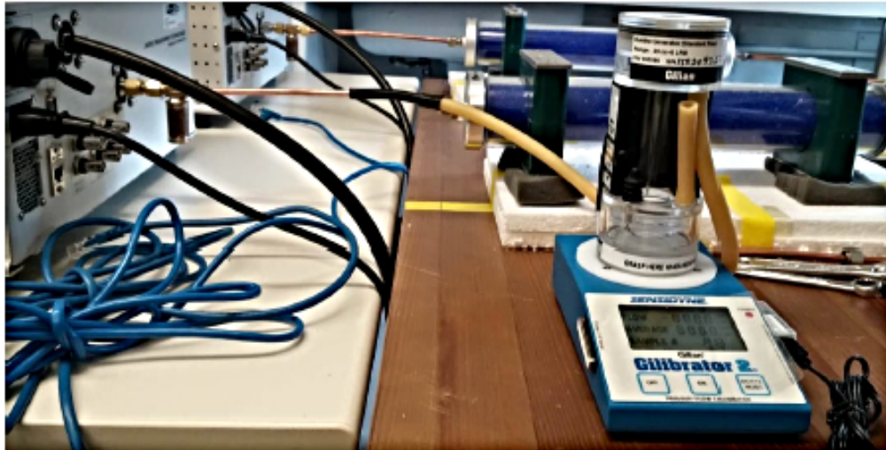
Figure 8. Montage fait avec le Gilibrator 2 , de la compagnie Gilian ® sur le PAX.
