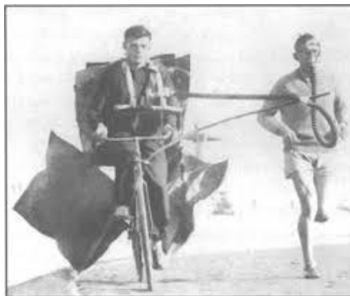
Figure 2 : Recueil des gaz expirés pendant l'exercice à l'aide des sacs de Douglas, fait à Berlin en 1928 par Kost (tiré de Hollmann et Prinz, 1997)
