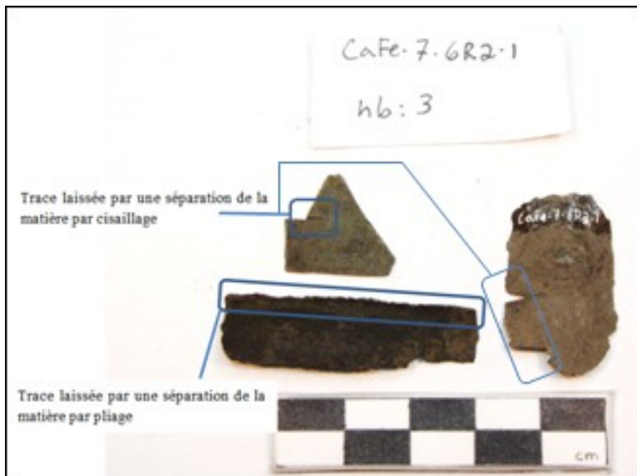
Figure 36 : Traces de cisailage et de pliage
