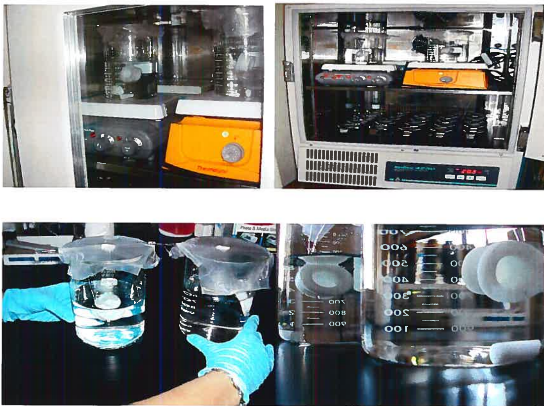
Figure 8. Déploiement d'un assemblage DGT au laboratoire
