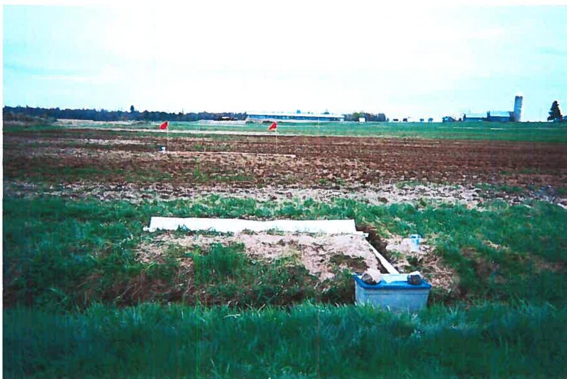
Figure 1. Dispositif de collecte des eaux de ruissellement. Le bas de la parcelle (côté de la bordure du champ) est délimité par la gouttière alors que le haut est délimité par deux drapeaux rouges.
