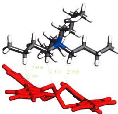
Figure 2.31 : Représentation de certaines interactions intermoléculaires (CH-aromatique et CH-O) entre un borate et un contre-ion dans la structure du sel 6 . Les interactions présentes ne sont pas toutes montrées pour plus de clarté.
