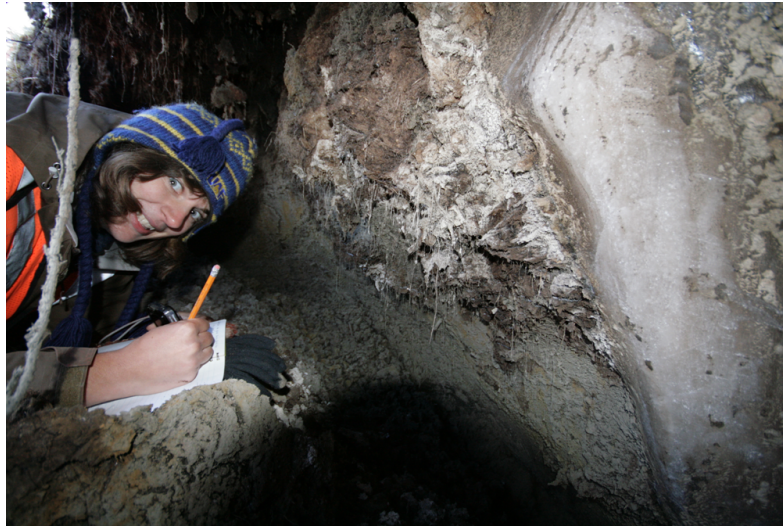
Figure 1.5 – Coin de glace inactif exposé à proximité de la tranchée drainante près de la Alaska Highway, Beaver Creek, YT. Cette exposition fut une conséquence des changements des conditions de surface qui résulta en un franchissement du seuil menant à des perturbations. La thermo-érosion résultante provoqua des tassements et un petit ravin qui se stabilisera dans ces nouvelles conditions (Photo saisie le 28 Août 2011). Crédits : Michel Sliger. Isabelle de Grandpré sur la photo fait figure d'échelle.
