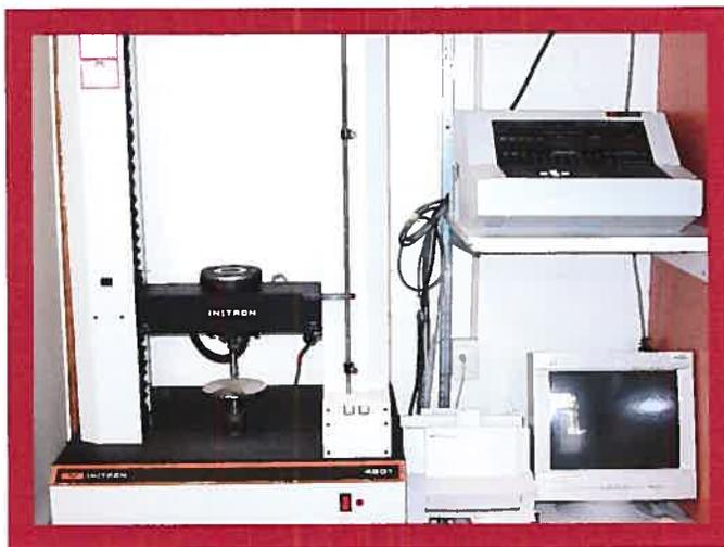
**Figure 26 : Appareil Universel Instron 4201
