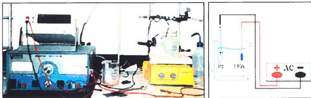
Figure 4.6 : Photo et schéma de l'ensemble du montage pour les tests de coloration comprenant la cellule électrochimique à un seul compartiment, l'agitateur magnétique, la source de courant ac et le voltmètre.
