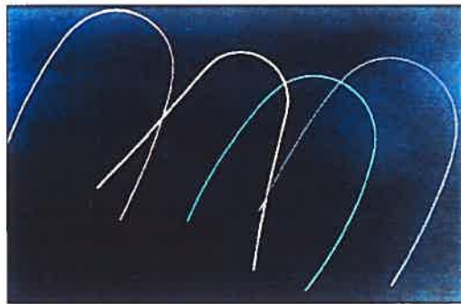
Figure 2.22 : Coloration des fils TMA par implantation ionique.
