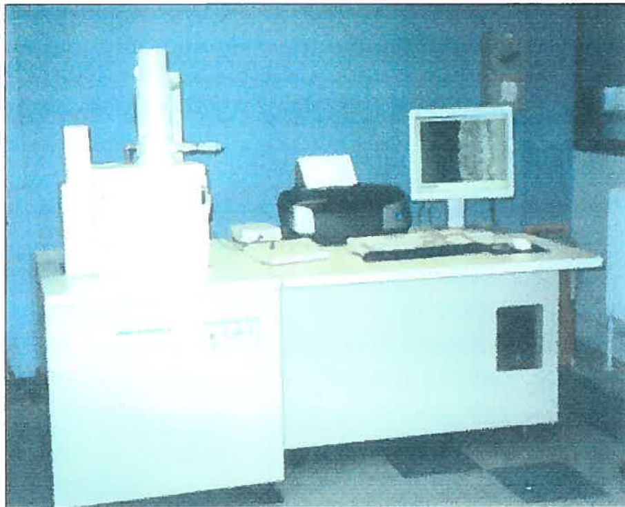
Figure 4.4 : Microscope électronique à balayage à pression variable de marque JSM-6460LV.
