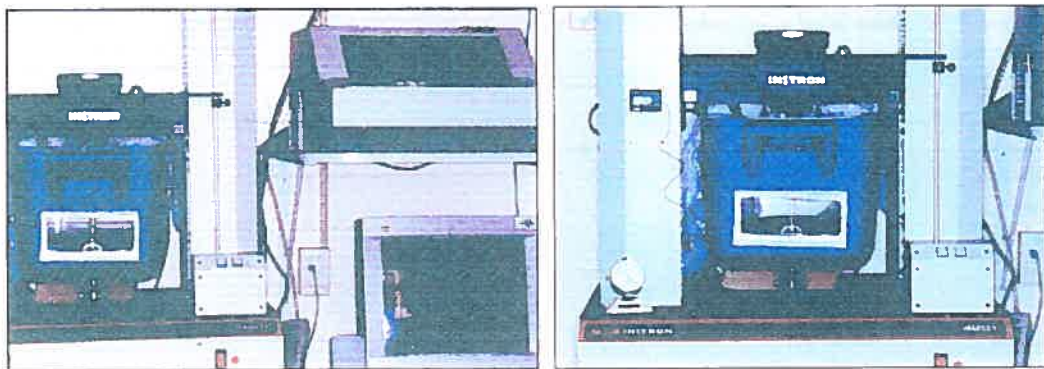
Figure 4.5 : Ensemble du montage comprenant le bassin de tests, la machine de test Instron 4201 et la console de tests Instron.
