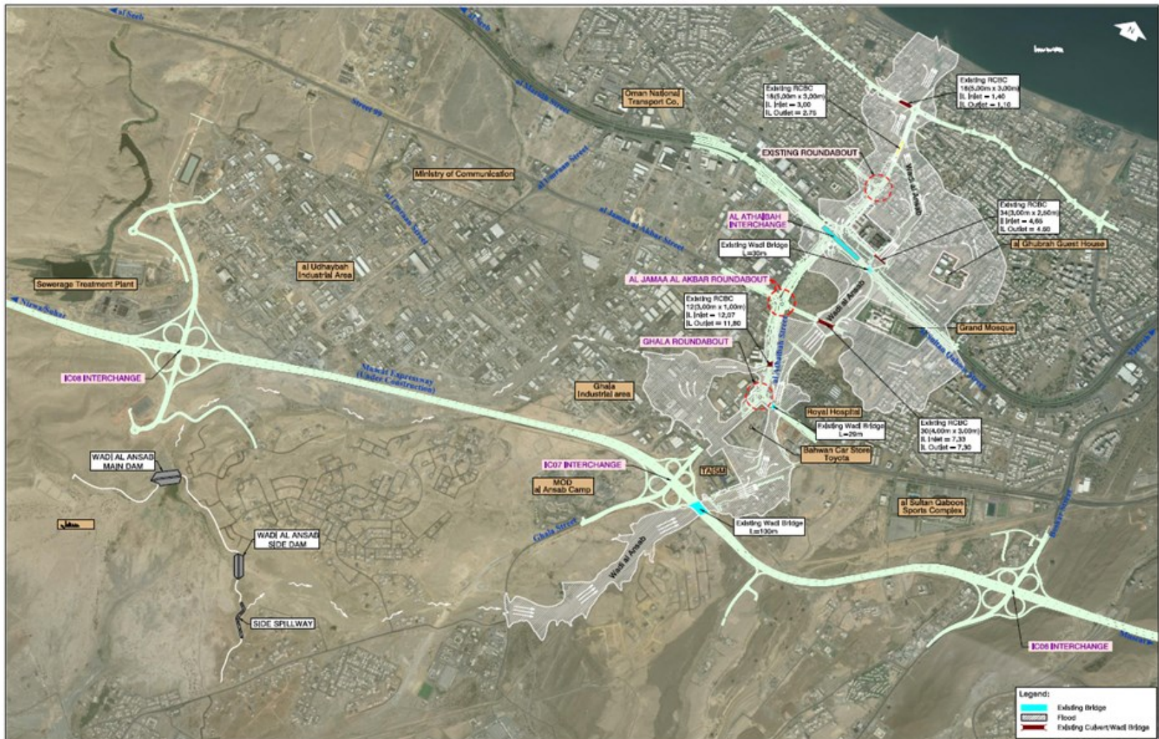
Figure 42 : Conséquence d'une inondation (période de récurrence de 100 ans) sur le réseau routier avoisinant l'oeud Al Ansab
