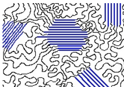
Figure 1.4 – Représentation des régions amorphes (en noir) et cristallines (en bleu) d'un polymère [23].
