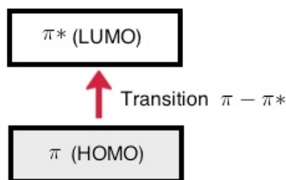
Figure 1.3 – Schéma de la chaîne d'un polymère conjugué qui se comporte comme un semi-conducteur avec énergie de gap ( \pi - \pi^* ), la bande de Valence ( \pi -HOMO) et la bande conduction ( \pi^* -LUMO).
