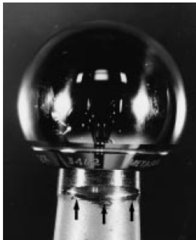
Fig. 38. Encoche présente sur la surface antérieure du col prothétique. Modifié de [207].
