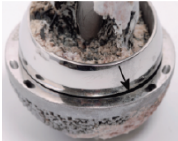
Fig. 28. Usure périphérique au niveau d'un implant de resurfaçage. Modifié de [122].
