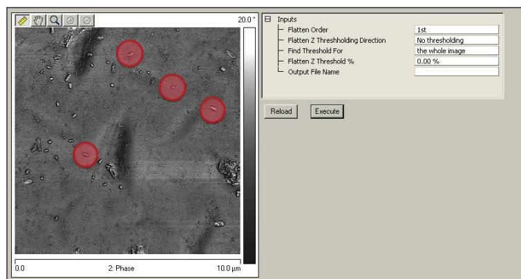
Figure I.2 – Image AFM de 100\mu\text{m}^2 prise sur l'échantillon de MN648C. Les cercles rouge montrent des régions de 1\mu\text{m}^2 .
