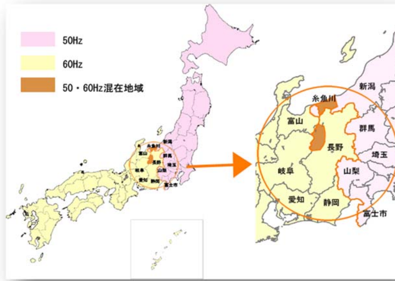
Figure 4: Zones de fréquence électrique (Source : Sharp corporation)
