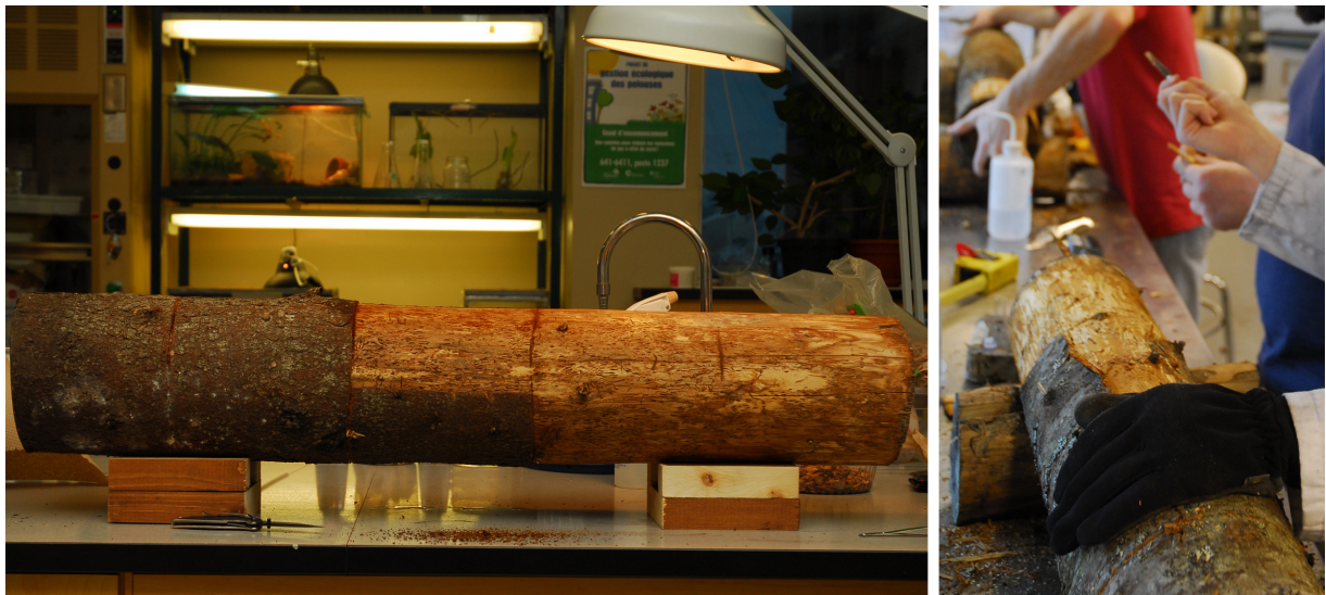
Fig. 1.3 : Processus de dissection (écorçage) de sections de troncs d'arbres après leur exposition en forêt (voir Chapitre 3, Fig. 3.1a).
