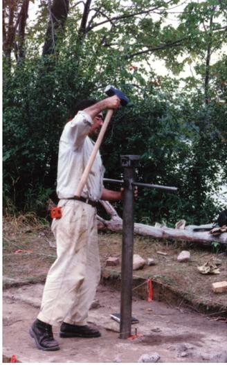
Photo C7 : fonçage du carottier avec la masse de 20 lbs.
