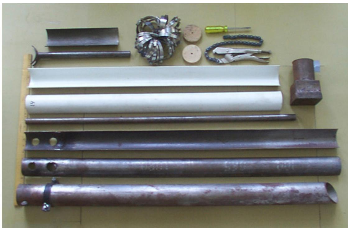
Photo C1 : les pièces du carottier et un boîtier de transport (en blanc).
