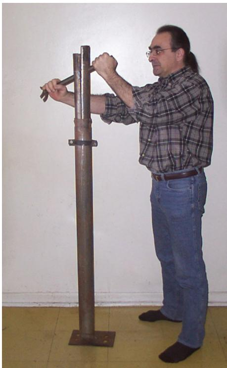
Photo C5 : ajustement des cuillères dans le tube.
