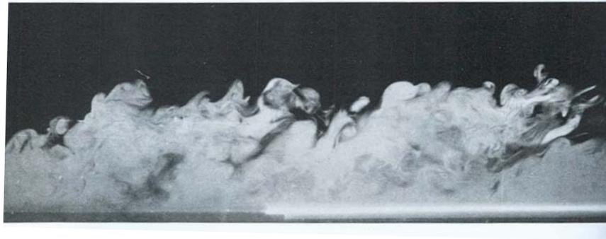
**FIGURE 1.9:** Image d'une structure turbulente à grande échelle dans une couche-limite turbulente. L'image a été obtenue lors de l'expérience de Falco (1977) qui s'est déroulée dans un tunnel de vent. Tirée de Van Dyke (2007).
