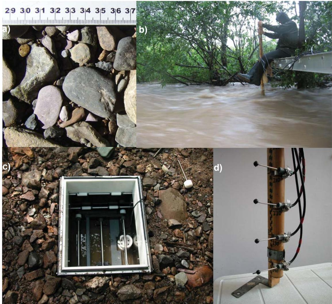
**FIGURE 2.1:** a) Sédiments qui composent le lit du ruisseau Béard. b) Crue du 28 août 2011 lors de l'ouragan Irène. c) Trappe à sédiments avec une cellule de charge placée au fond de la trappe. d) Courantomètres électromagnétique, ECMS.
